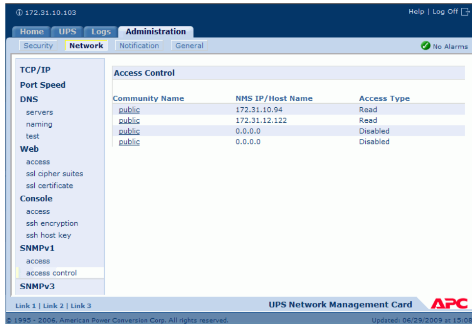
Figure 321. Fenêtre Access Control (Contrôle d'accès)
